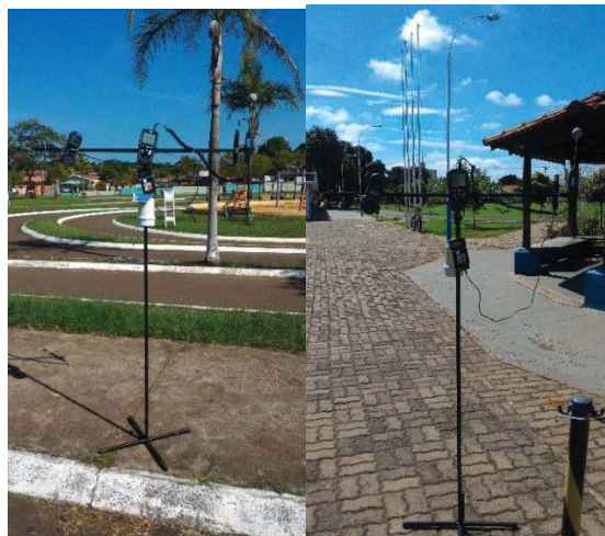
Figura 4 - Instrumentos utilizados para medição de temperatura e velocidade do ar e temperatura de globo
